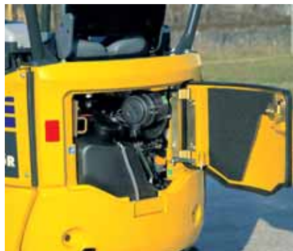
Hintere Wartungsklappe: schnelle Motorinspektion und Betankung
