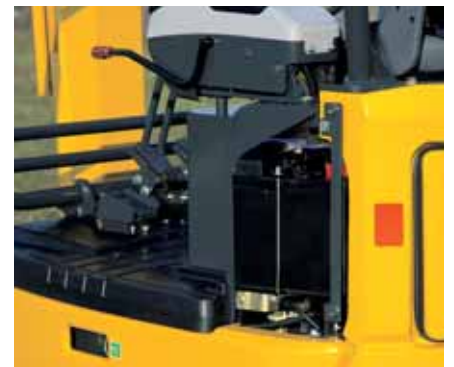
Linke Wartungsklappe: leichter Zugang zur Batterie
